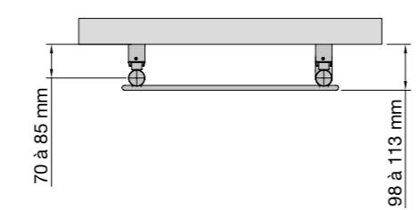
CÂBLE : SORTIE À DROITE (LONGUEUR UTILE : 1000 MM)
